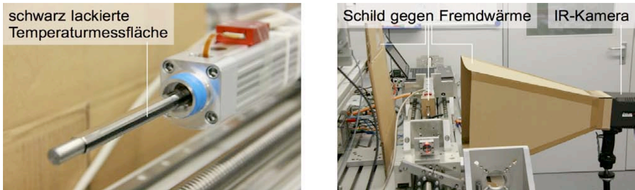
Abb. 6.10: Vorrichtung zur Messung der Temperaturverteilung auf der Kolbenstange. Links: schwarz lackierte Temperaturmessfläche. Rechts IR-Kamera und Vorrichtungen zur Abschirmung von Fremdwärme.
