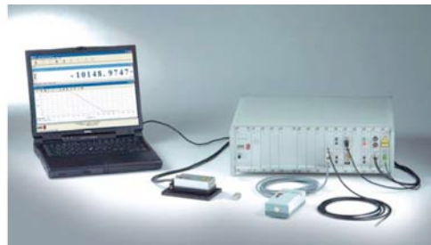
Abb._A2.78: Miniatur-Interferometer mit Lichtleiterankopplung. Links: Optik-Gehäuse. Rechts: System aus Optik-Gehäuse, Lichtquelle und PC. Quelle: [Sios05].
