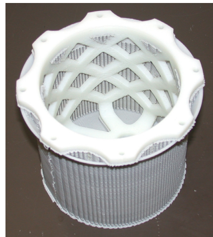
Abbildung 7.2: Skelettdeckel (Ansicht von unten, mit Stützkonstruktion)
