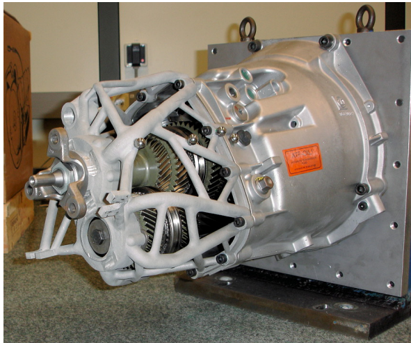
Abbildung 7.9: Gehäuse mit montiertem Skelettdeckel
