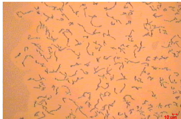
Abb. 5.1: Ph-T-F C auf Suprasil, UHV-Aufdampfschichten; unterschiedliche Schicht-Strukturen im Interferenz-Kontrast-Mikroskop; a) Inseln (Vergrößerung 1000fach), b) und c) Aggregate des Typs I und II (Vergrößerung 1000fach), d) und e) Dendriten des Typs I und II (Vergrößerung 200fach); die Bildbalken entsprechen jeweils 10μm.
