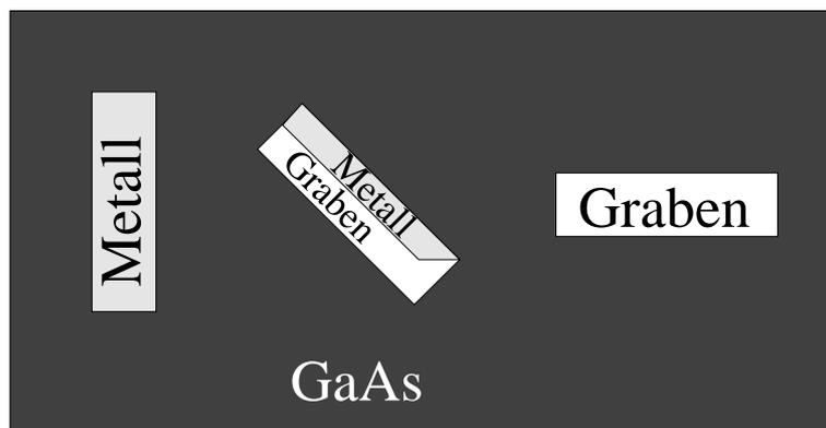
Abbildung C.2: Durch Wahl des Winkels zwischen EBEAM-definierter Linie und der Aufdampfrichtung läßt sich das Verhältnis zwischen metallischer Leiterbahn und isolierendem Graben definieren. (a) Zeigt die zugrundeliegende Lackmaske, (b) das zugehörige Ergebnis nach Anwendung der in Abbildung C.1 gezeigten Prozeßschritte.
