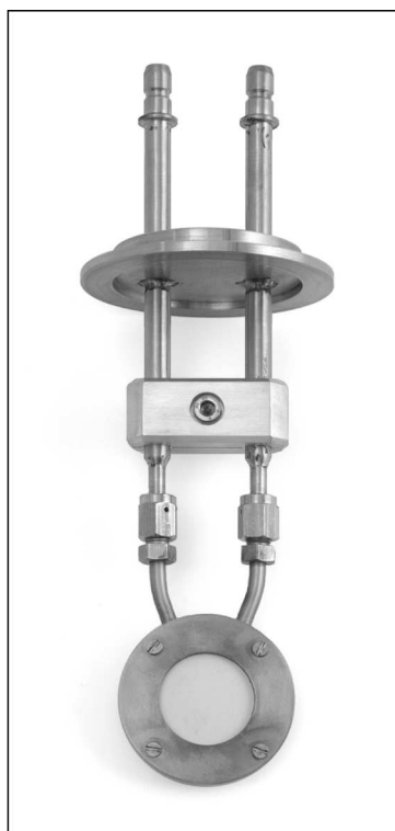
Abbildung 3.1: Bei Tests der neuen Target-Backings für das Drehtisch-Experiment wurden einfacher gestaltete Targets verwendet. Der Targetträger besteht aus einem einfachen Kupferblech, das von hinten bei einem mittleren Druck von 4.5 bar wassergekühlt wird.
