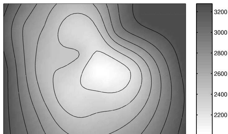
Abbildung A.12: Target O-14: Effektive Anfangs-Targetbelegung 3280 \times 10^{15} \text{ cm}^{-2} , effektive End-Targetbelegung 2480 \times 10^{15} \text{ cm}^{-2} , Targetabbrand 24 %.
