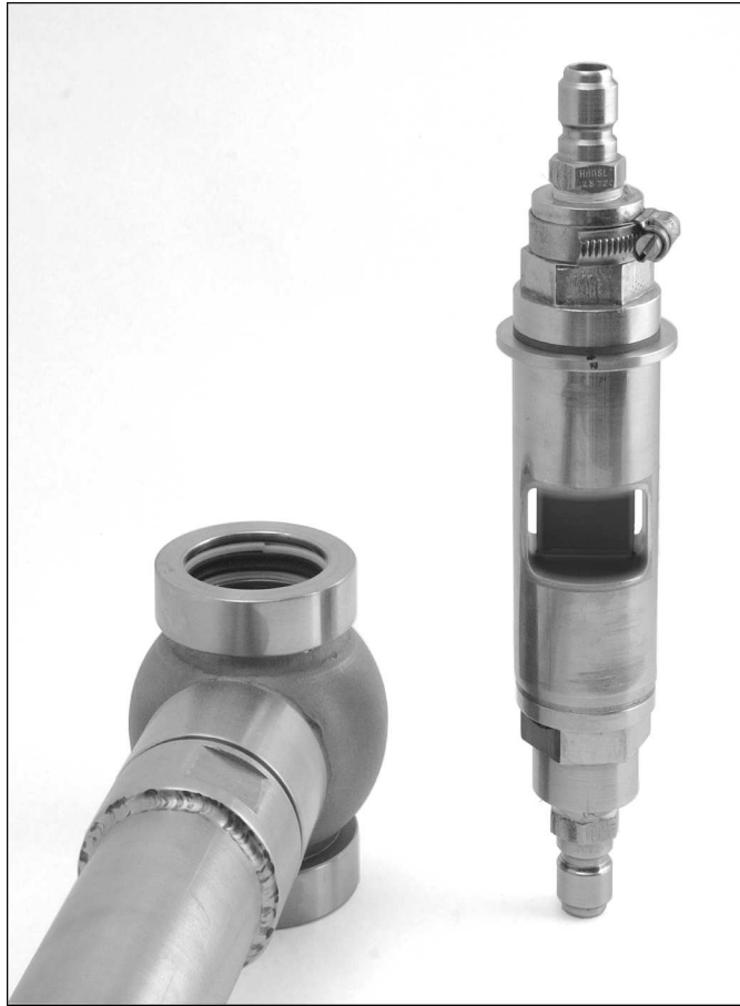
Abbildung 3.9: Hochstromtarget für das EUROGAM-Array-Experiment mit eingeschraubten Wasseranschlüssen und der zugehörigen Targetkammer. Dieser Targettyp wurde für Messungen entwickelt, bei denen die Detektoren in einer Ebene um das Target herum angeordnet sind. Bei einem Aufbau mit 4\pi -Geometrie reduzieren die massiven Wasseranschlüsse die Nachweiswahrscheinlichkeit der von oben beziehungsweise unten auf das Target gerichteten Detektoren (siehe auch Abbildung 3.15).
