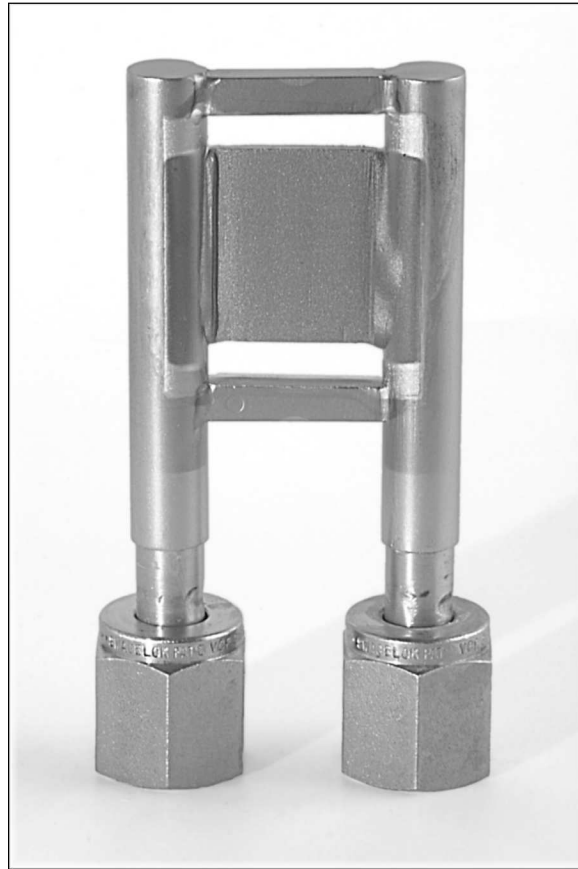
Abbildung 3.14: Hochstromtarget beim Drehtisch-Experiment. Die geringere Absorption von Photonen in der Targetfassung und die kompaktere Bauweise resultiert in höherer absoluter Nachweiswahrscheinlichkeit.
