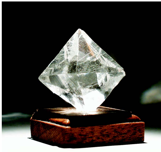
Abb. 3.1: \text{CaF}_2 -Kristall, der aus einem Rohling herausgespalten wurde. Die Spaltflächen liegen senkrecht zur [111] -Richtung der Fluor-Kuben des Kristallgitters. Weitere Erläuterungen im Text.
