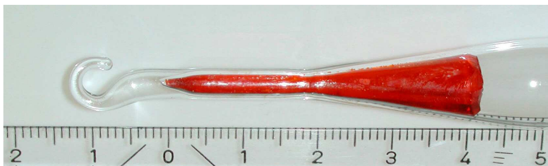
Abb. 3.7: Mit der Gasphasen-Bridgman-Methode gezogener Tetracen-Kristall
