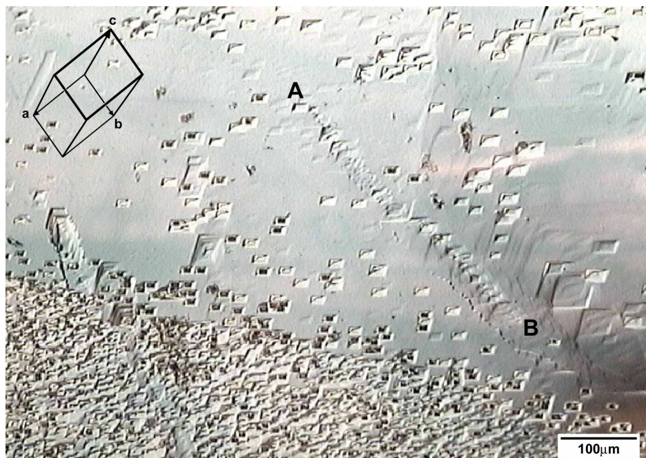
Abb. 4.14: Oberfläche eines mit Oleum angeätzten Sublimationskristalls. Die Einheitszelle zeigt die Orientierung des Kristalls.
