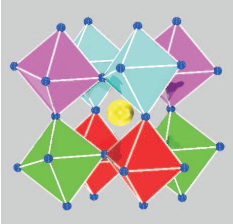
Abbildung 3.13: Dreidimensionale Darstellung der P2_1/m -Struktur. Die Sauerstoff-Oktaeder, die das Mangan-Ion umgeben, sind entsprechend ihrer Verkippung unterschiedlich eingefärbt.
