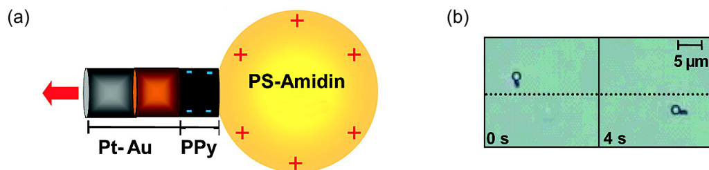
Abb. 2.13: (a) Andocken einer Ladung an einen Pt-Au-Motor durch elektrostatische Wechselwirkung zwischen einem negativen PPy-Ende und einem positiv geladenen PS-Amidin-Kügelchen. (b) Mikroskopaufnahmen eines Pt-Au-PPy-Stäbchens, der ein Kügelchen mit einem Durchmesser von 1,05 \mu\text{m} über 4 s mit sich zieht. [58]
