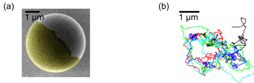
Abb. 2.7: (a) Mikroskopaufnahme eines mit Gold bedampften Silicakügelchens. (b) Innerhalb von 10 s aufgenommene Trajektorien von Janusteilchen in Wasser, die aufgrund der Beleuchtung durch einen Infrarotlaser eine thermophoretische aktive Brown'sche Bewegung ausführen. [10]
