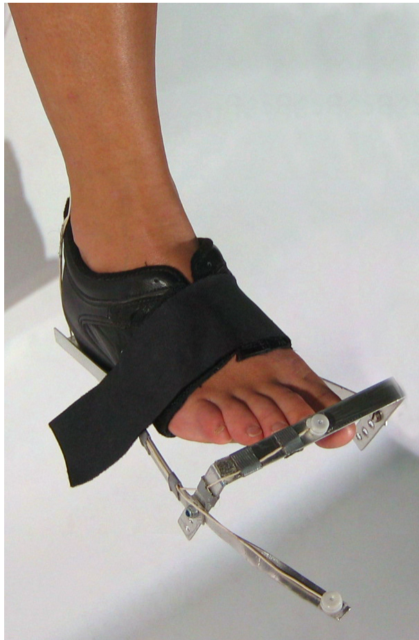
Abbildung 39: Prototyp der Ultraschallmarkerbefestigung, angebracht am Probandenfuß. Zu sehen ist, dass der Vorfuß nicht vom Schuh mit eingeschlossen wird. Das Klettband drückt die hintere Schuhschale gegen das Fersenbein. Bei einer Bewegung folgen die Marker der Bewegung des Calcaneus.
