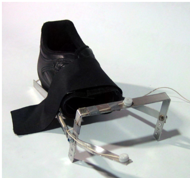
Abbildung 38: Prototyp der Ultraschallmarkerbefestigung. Das Klettband dient zur Befestigung des Schuhs am Probandenfuß. Der in der Mitte des Aluminiumbügels angebrachte Marker dient zur Bestimmung der OSGA Parameter und wird vom CMS 20 auf Kanal 3 eingezogen. Der rechte Ultraschallmarker liefert die zur Berechnung der USGA Parameter benötigten Koordinatendaten und wird vom CMS 20 auf Kanal 4 eingezogen.
