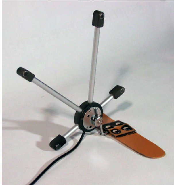
Abbildung 36: Prototyp der Ultraschallsensorbefestigung. Die Sensorbefestigung verfügt über zwei Gelenke. Der Sensor kann so optimal unabhängig von interindividuellen Unterschieden an der Tibia des Probanden angebracht werden. Das Gesamtgewicht beträgt m = 50g . Die Haltevorrichtung besteht aus einem leicht flexiblen Kunststoffband, das mit Hilfe von doppelseitigem Klebeband auf die Tibia geklebt werden kann. Am Kunststoffband wiederum ist ein Metallstift befestigt, an dem über ein Gelenk die magnetische Halterung für den JMA Sensor angebracht ist. Der Sensor kann so unkompliziert auf der Halterung befestigt werden. Die gesamte Vorrichtung ist so konstruiert, dass es möglich ist, die Sensoren unabhängig von der interindividuellen Beingeometrie optimal auf die Ultraschallsender auszurichten.
