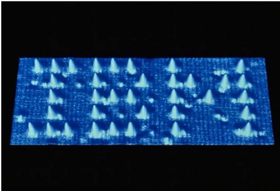
Abbildung 5: Der Schriftzug IBM aus Xenon-Atomen im Rasterelektronenmikroskop 23
