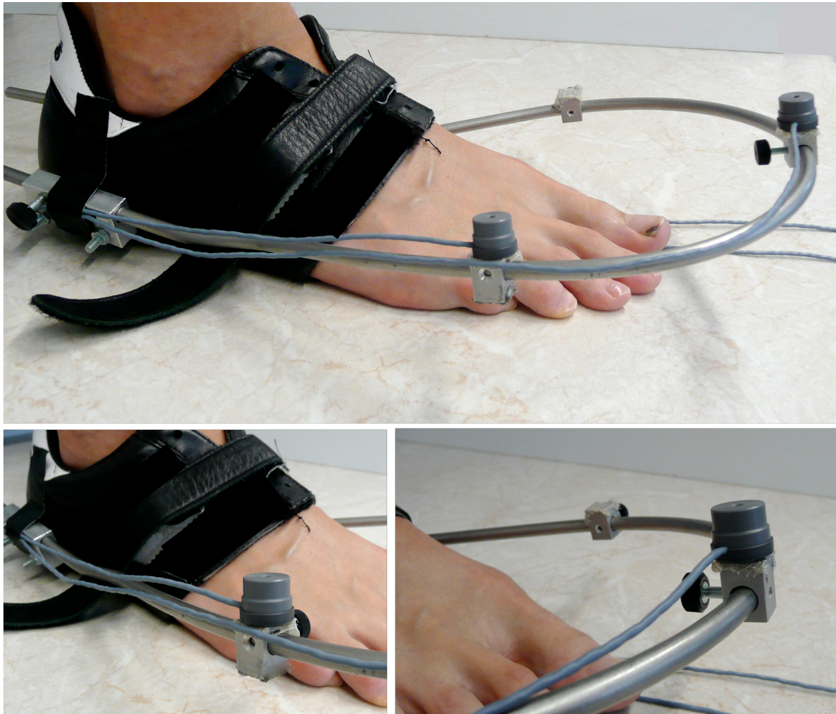
Abbildung 21: Ultraschallsenderbefestigung an einem rechten Fuß (Ultraschallsender: Zebristechnologie©).
