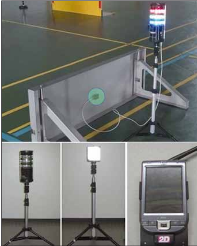
Abbildung 67: Smartspeed-Anlage (oben Bewegungssensor »SmartShoxx« an Rückprallwand, unten links: Lichtschrankensystem; unten rechts: Steuerungsinstrument: PDA)
