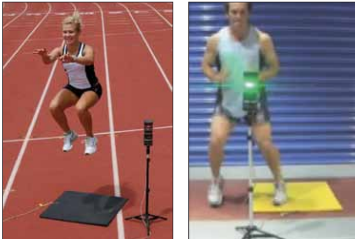
Abbildung A.5: Kontaktmessplatte des Smartspeed Messsystems der Firma Fusion Sport und Testdurchführung (vgl. www.ergometrisi.com )
