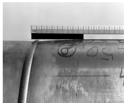
Bild 3-10 : Radialer Schrumpf im Nahtbereich
