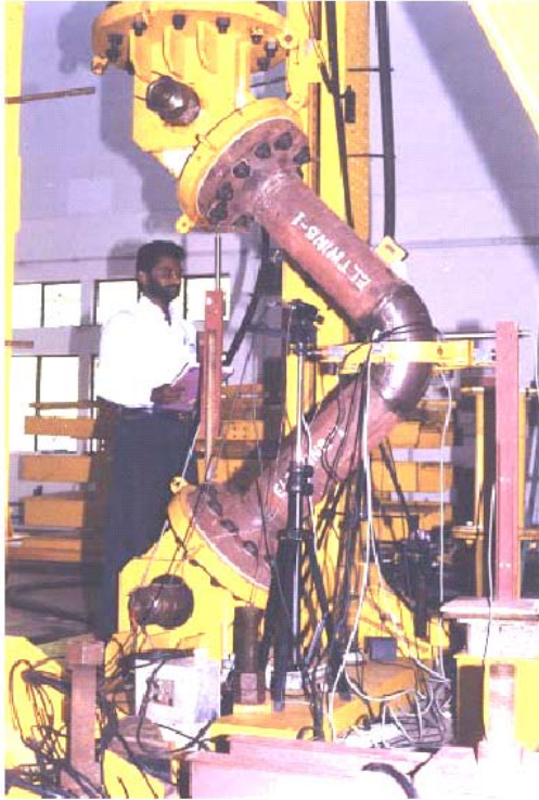
Bild Z-9 Testaufbau eines Rohrbiegeversuchs Bild Z-10 Typische Rohrbogen-Testdaten
