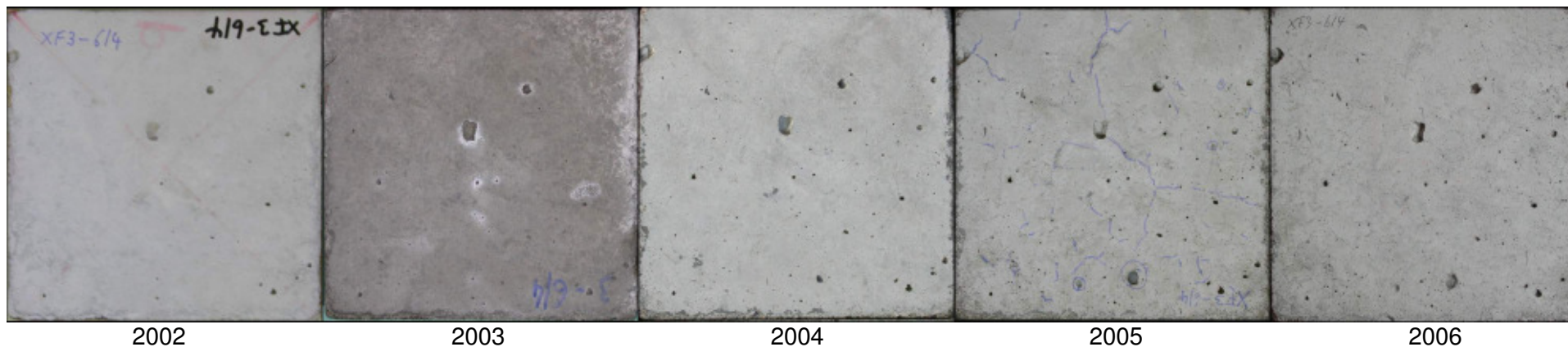
Bild 62: Bildserie der Prüffläche des Probekörpers XF3-6/4 nach der Herstellung (2002) und im Frühjahr der Jahre 2003 bis 2006.
