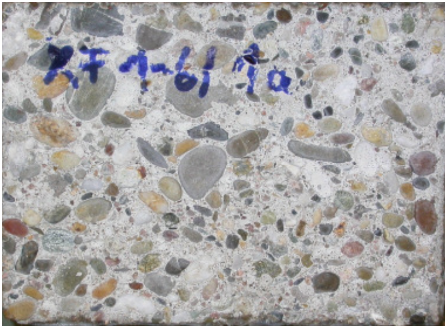
Bild 19: Foto der Prüffläche der Laborprobe XF1-6/1 nach 56 Frost-Tau-Wechseln der CIF-Prüfung (Abwitterungsgrad: 5,0).
