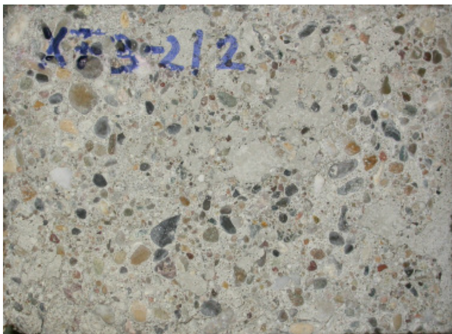
Bild 21: Foto der Prüffläche der Laborprobe XF3-2/2 nach 56 Frost-Tau-Wechseln der CIF-Prüfung (Abwitterungsgrad: 2,7).
