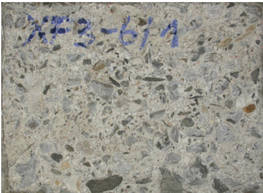
Bild 23: Foto der Prüffläche der Laborprobe XF3-6/1 nach 56 Frost-Tau-Wechseln der CIF-Prüfung (Abwitterungsgrad: 3,6).
