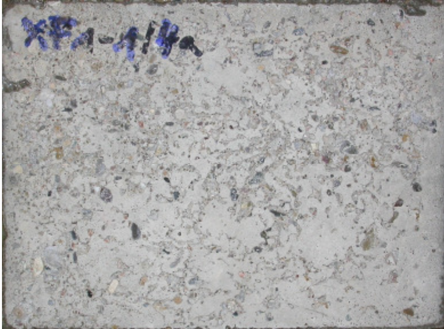
Bild 11: Foto der Prüffläche der Laborprobe XF1-1/4 nach 56 Frost-Tau-Wechseln der CIF-Prüfung (Abwitterungsgrad: 0,6).
