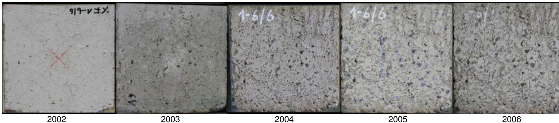
Bild 58: Bildserie der Prüffläche des Probekörpers XF1-6/6 nach der Herstellung (2002) und im Frühjahr der Jahre 2003 bis 2006.
