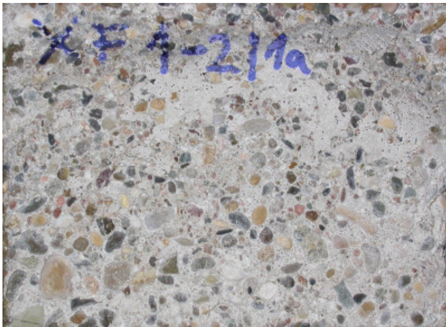
Bild 12: Foto der Prüffläche der Laborprobe XF1-4/1 nach 56 Frost-Tau-Wechseln der CIF-Prüfung (Abwitterungsgrad: 2,7).
