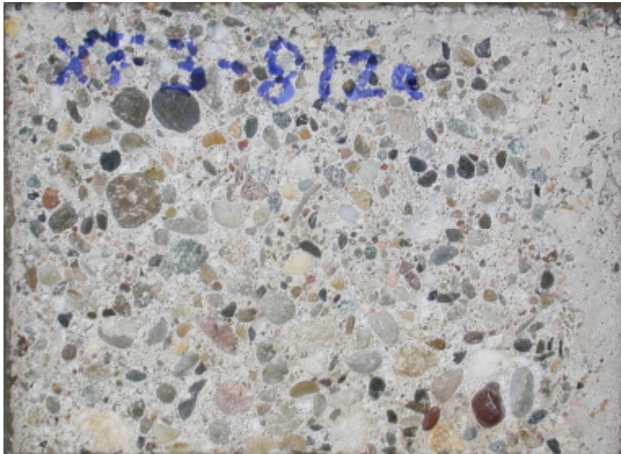
Bild 27: Foto der Prüffläche der Laborprobe XF3-8/2 nach 56 Frost-Tau-Wechseln der CIF-Prüfung (Abwitterungsgrad: 2,7).
