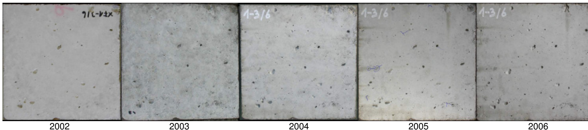
Bild 55: Bildserie der Prüffläche des Probekörpers XF1-3/6 nach der Herstellung (2002) und im Frühjahr der Jahre 2003 bis 2006.
