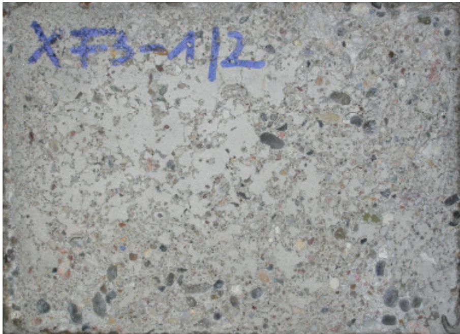
Bild 20: Foto der Prüffläche der Laborprobe XF3-1/2 nach 56 Frost-Tau-Wechseln der CIF-Prüfung (Abwitterungsgrad: 1,2).
