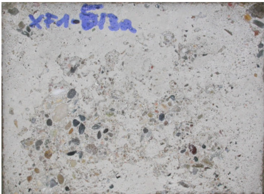
Bild 18: Foto der Prüffläche der Laborprobe XF1-5/3 nach 56 Frost-Tau-Wechseln der CIF-Prüfung (Abwitterungsgrad: 0,8).
