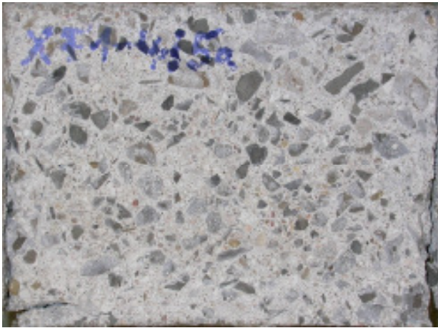
Bild 16: Foto der Prüffläche der Laborprobe XF1-4/5 nach 28 Frost-Tau-Wechseln der CIF-Prüfung (Abwitterungsgrad: 5,0).
