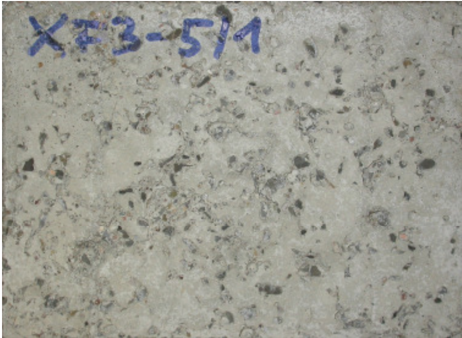
Bild 22: Foto der Prüffläche der Laborprobe XF3-5/1 nach 56 Frost-Tau-Wechseln der CIF-Prüfung (Abwitterungsgrad: 0,6).
