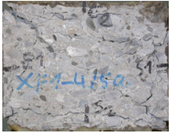
Bild 17: Foto der Rückseite der Laborprobe XF1-4/5 nach 28 Frost-Tau-Wechseln der CIF-Prüfung.
