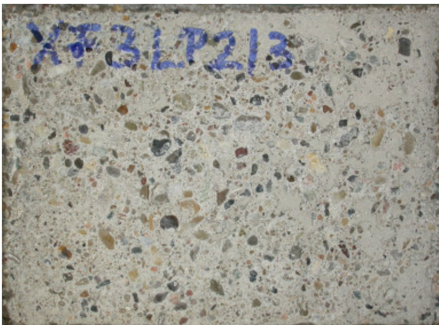
Bild 29: Foto der Prüffläche der Laborprobe XF3LP-2/3 nach 56 Frost-Tau-Wechseln der CIF-Prüfung (Abwitterungsgrad: 1,8).
