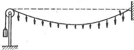
Abb. 4: Von Kulibin benutztes Vieleck zur Bestimmung des optimalen Verlaufs eines Bogens
