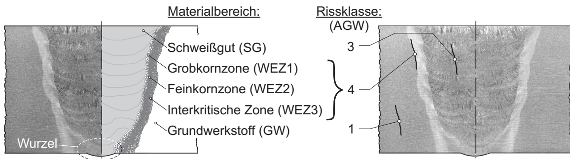
Bild 3.10: Einteilung einer Schweißnaht in fünf Materialbereiche (links) und Rissklassifizierung einer gleichartigen Schweißverbindung nach AGW [Arb03] (rechts)
