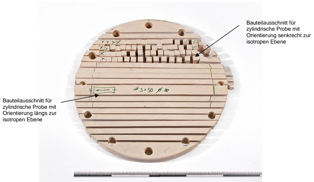
Bild 4.25: Blindflansch DN 300 mit ebener Orientierung der SMC-Matten; Entnahme der Bauteilausschnitte für zylindrische Proben
