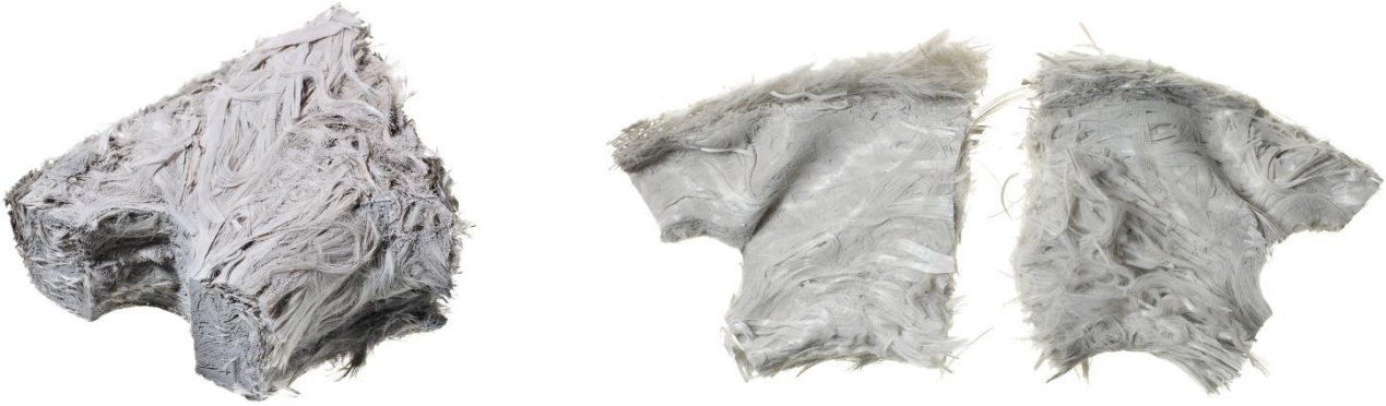
Bild 4.4: Veraschtes Segment eines SMC-Losflansches (links) und unregelmäßige Verteilung der Fasermatten im aufgeklappten Zustand (rechts)
