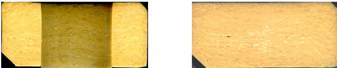
Bild 4.48: Schnitt durch den optimierten Losflansch mit annähernd ebenem Lagenaufbau
