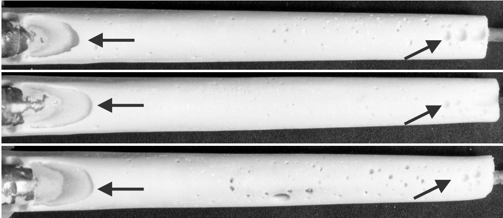
Abb. 6-17: Mediale Ansicht der Zementköcher V 1/4a-c mit massiven Füllungsdefekten als Folge eines zu hohen Zementvolumenstroms ( \eta_{\text{Start}} = 10 \text{ Pas} , v_{\text{KInj.}} = 4,0 \text{ mm/s} )
