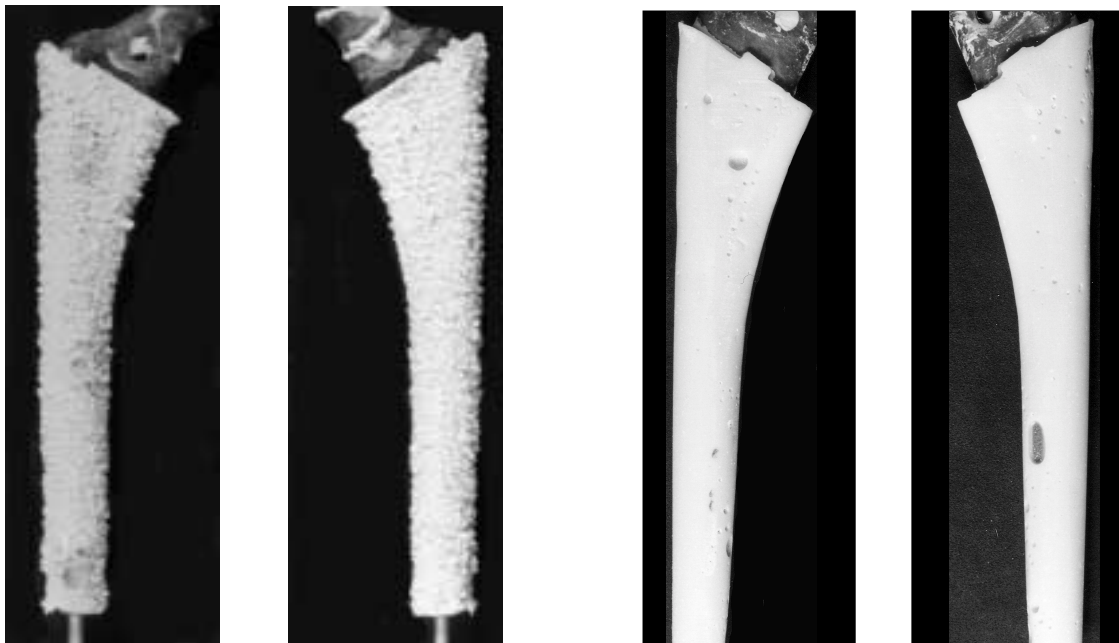
Abb. 6-5: Beispielhafte Darstellung der Knochenzementpenetration in den Gasbetonstein (links) und zur optischen Vermessung vorbereiteter Zementköcher mit zahlreichen Fehlstellen (rechts)
