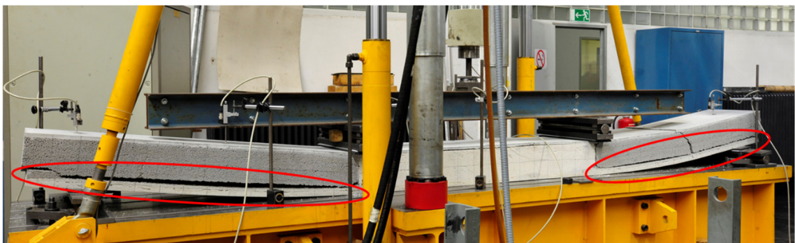
Abb. H-3: Versagen des Prüfkörpers V0.1 in der Längsfuge auf dem Prüftisch der MPA Stuttgart
