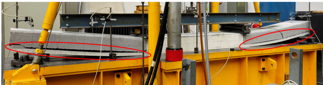
Abb. 5-13: Versagen des Bauteils V0.1 in der unteren Längsfuge
