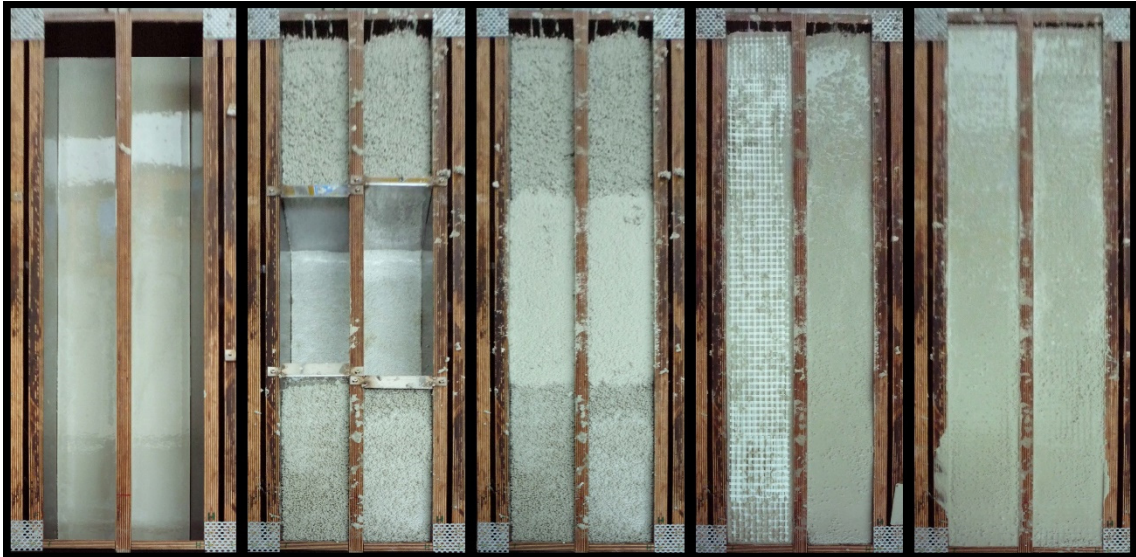
Abb. 3-8: Fertigung eines Gradientenbetonträgers im Schichtenverfahren
