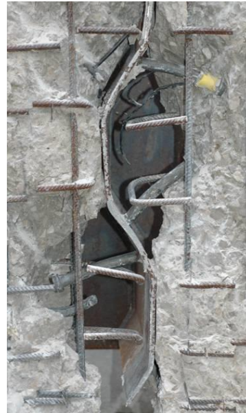
Bild 6.52: Bolzenverformung am Körper KBD2 Bild 6.53: Bolzenverformung am Körper KBD3-1
