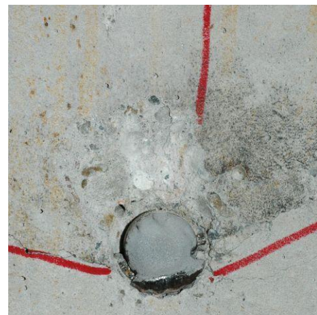
Bild 4.13: Lokale Betonzermürbung auf der lastzugewandten Seite bei Körper QE1/6
