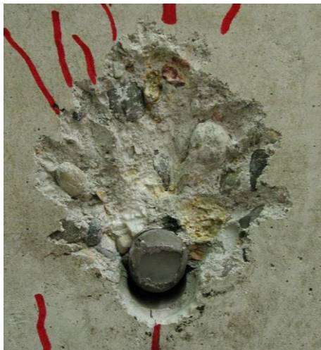
Bild 4.12: Lokale Betonzermürbung auf der lastzugewandten Seite bei randnahen Kopfbolzen unter Längsschub
