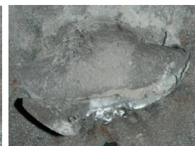
Bild 4.19: Zwei Rissebenen an einem Bolzen von Körper QE1/8; links: Ebene nach Typ A; rechts: Ebene nach Typ B
