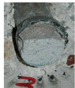
Bild 4.17: Risstyp B am Beispiel eines Bolzens von Körper QE1/7
