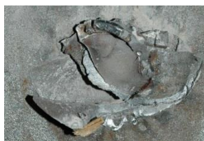
Bild 4.19: Zwei Rissebenen an einem Bolzen von Körper QE1/8; links: Ebene nach Typ A; rechts: Ebene nach Typ B
