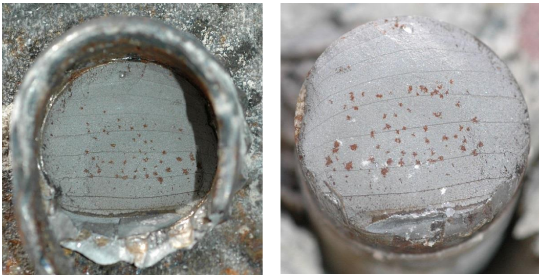
Bild 4.61: Rastlinien am Bolzen K11 des Körpers QE3-5
