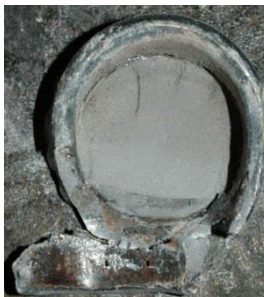
Bild 4.16: Risstyp A am Beispiel eines Bolzens von Körper QE1/7
