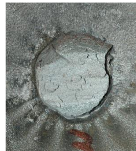
Bild 4.17: Risstyp B am Beispiel eines Bolzens von Körper QE1/7
