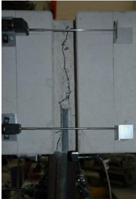
Bild 6.171: Typischer erster Riss (R-Q1) Bild 6.172: Aufbiegen des Stahlbetongurts bei Körper R-Q2
