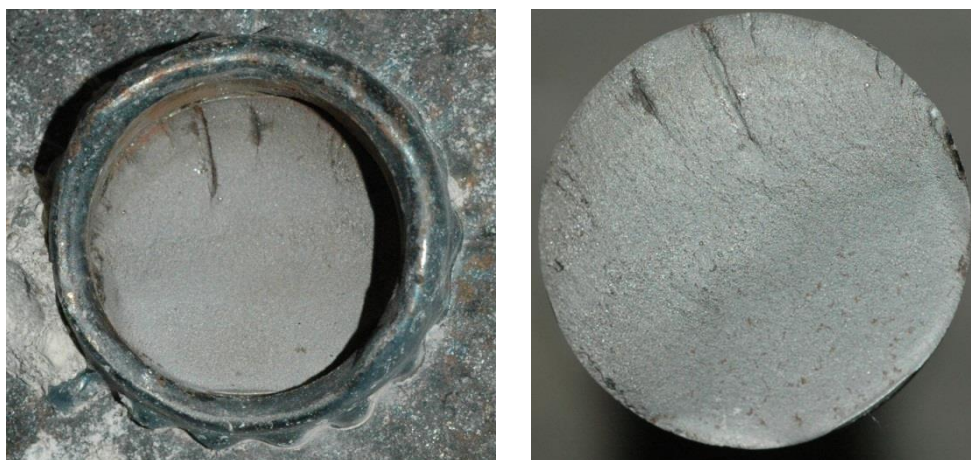
Bild 4.66: Bruchfläche Risstyp A mit vollständigem Schweißwulst bei Körper QE2/7
