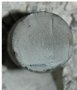
Bild 4.16: Risstyp A am Beispiel eines Bolzens von Körper QE1/7
