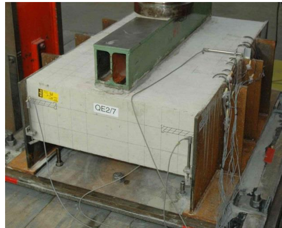
Bild 4.4: Eingebauter Versuchskörper mit Messeinrichtung
