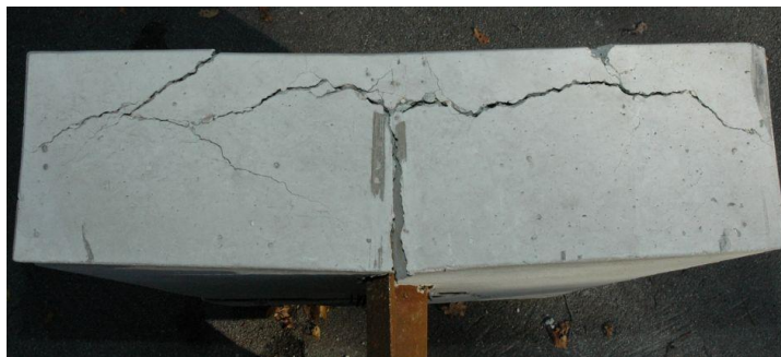
Bild 6.49: Risse (8) nach Versuchsende an der Oberseite von Körper KBD2
