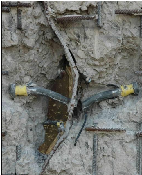
Bild 6.52: Bolzenverformung am Körper KBD2 Bild 6.53: Bolzenverformung am Körper KBD3-1
