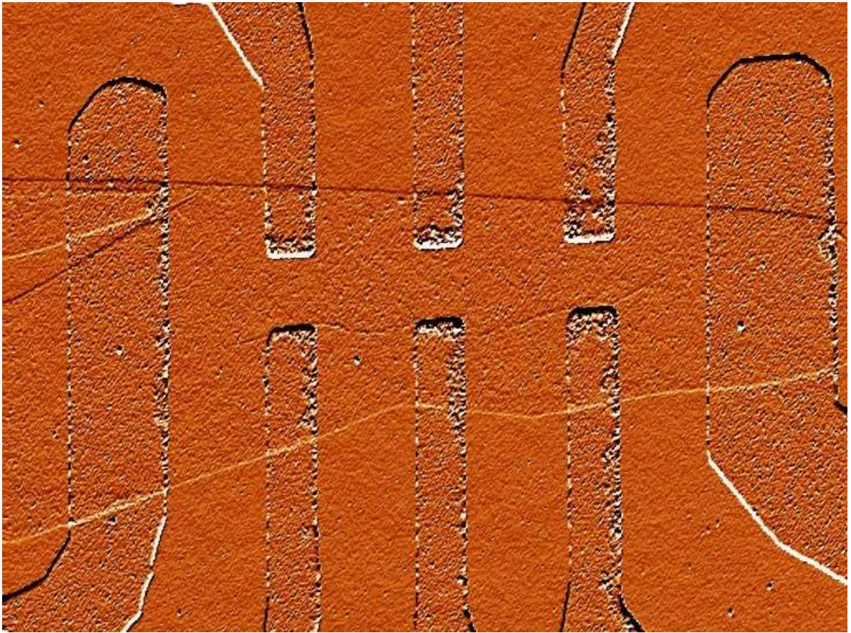
Abbildung 6.17: AFM-Bild einer fertig präparierten Graphen-Flocke (Bild aufgenommen von Dirk Obergfell)
