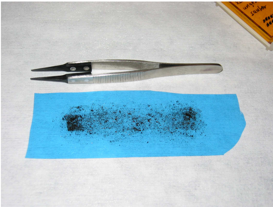
Abbildung 6.12: Nach 5 – 10-maligem Wiederholen des Zusammenklebens und Auseinander-Ziehens ist das HOPG ausreichend aufgespaltet
