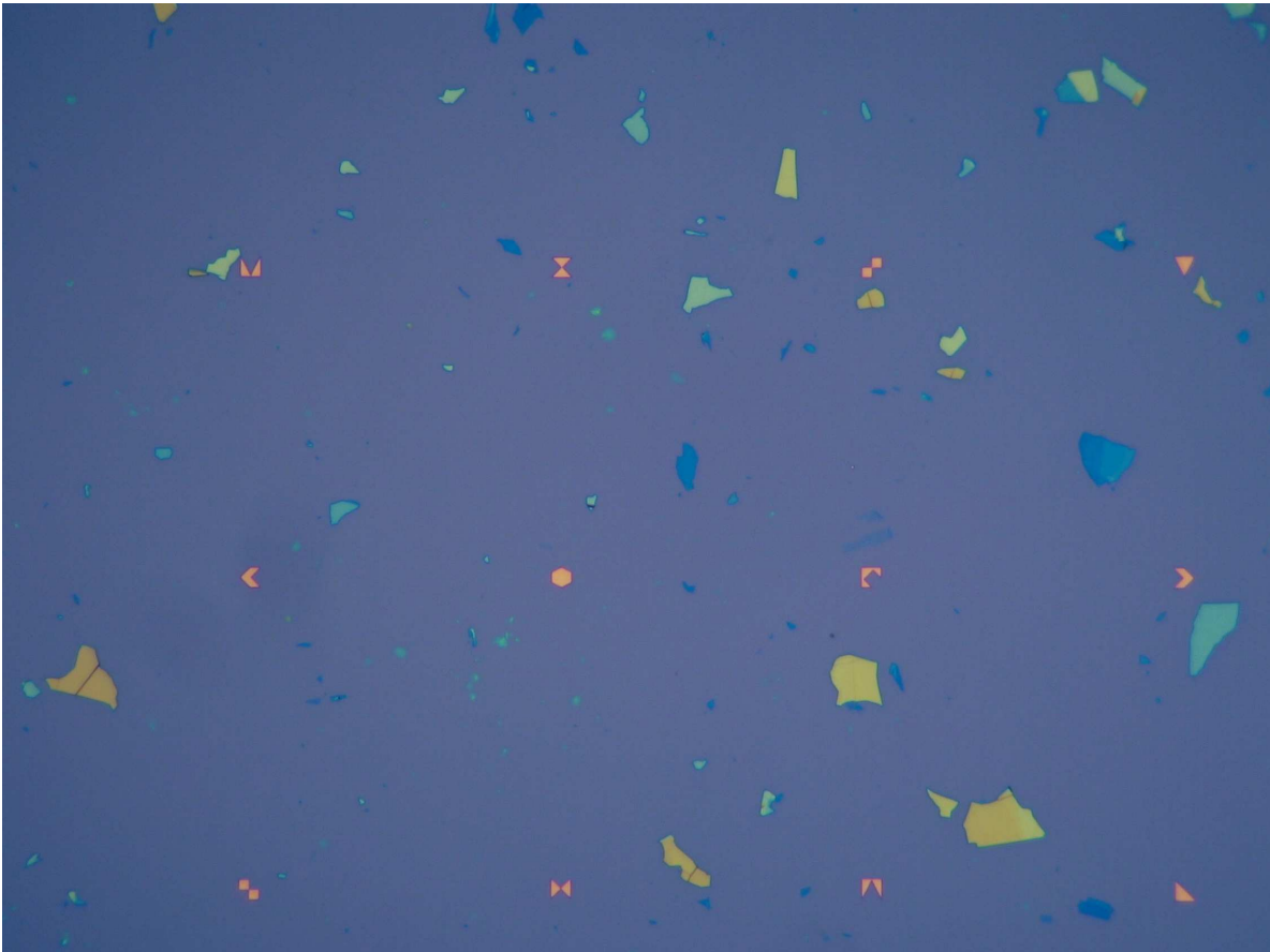
Abbildung 6.15: Substratoberfläche nach dem Abscheiden der Graphit-Flocken: In diesem Beispiel wurde eine relativ hohe Flockendichte hergestellt, sehr gut sind die vielfältigen Formen und die zufällige Lage der einzelnen Flocken zu erkennen. Die unterschiedliche Farbe der Flocken entsteht durch unterschiedliche Dicken und kann zur Identifikation der Monolagen verwendet werden, siehe Kapitel 6.2.3.
