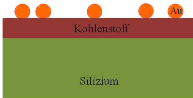
Abbildung 3.4: Schematische Darstellung der mit Goldkolloiden strukturierten Substrate.
