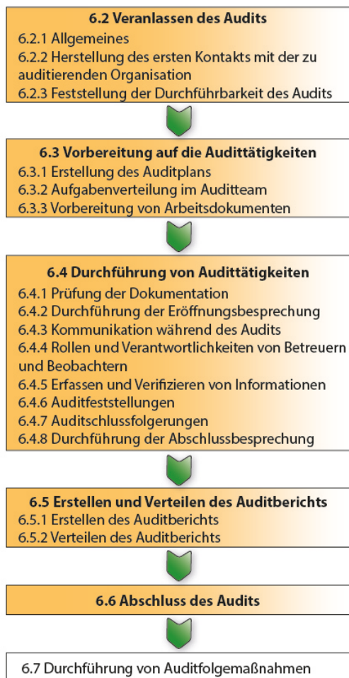
Abbildung 3-14: Überblick typischer Tätigkeiten während eines Audits [DIN 19011:2010, S. 21]
