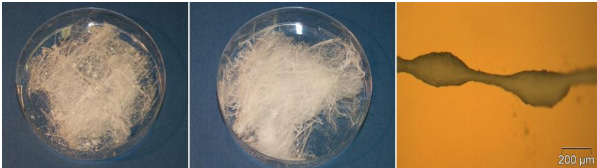
Abbildung 8.1: K6/PEO_35/1000 (60/40) Grünfasern aus RJS-Prozess; Grünfasermaterial am Spinnkopf ( links ) und am Kollektor entnommen ( rechts ) [61 Ges.Gew.-%, U = 3276 rpm, d = 35 cm, Kollektormaterial = Teflontgewebe].
