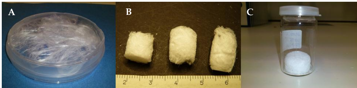
Abbildung 10.1: Grünfaserwatten aus Herstellungsverfahren im Labormaßstab (A), nach Formung resultierende Grünfaserwatten, 24-well Platte (B) sowie resultierende \text{CaO}/\text{P}_2\text{O}_5/\text{H}_2\text{O}/\text{HCl}/\text{Al}_2\text{O}_3 Keramikfaserwatte, 24-well Platte (C).
