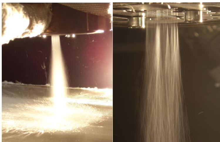
Abbildung 50: 30 mm Meltblow-System: Visualisierung der Faserbildungszone (links) und ungleichmäßige Schmelzeverteilung bei geringem Polymerdurchsatz (rechts)
