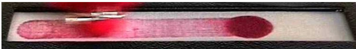
Abb. 32: Prüf- und Reibgewebe kurz nach einer Hinbewegung (1/2 Reibbewegung)
