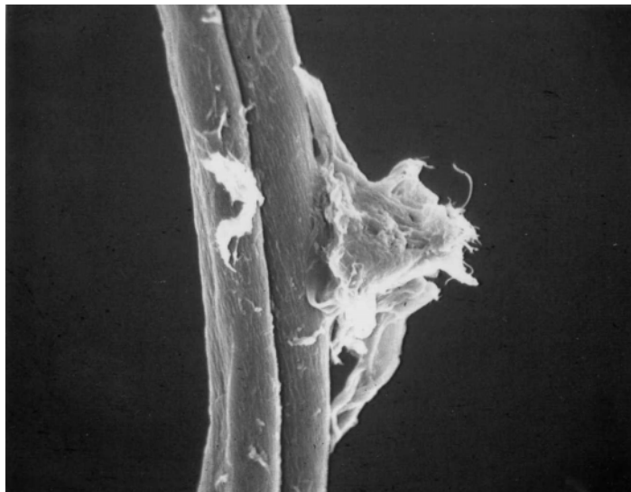
Abb. 43: Reibgewebeeeinzelfaser (BW) mit angelagerten gefärbten Faserfragmenten; 1:2000
