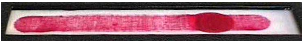
Abb. 33: Prüf- und Reibgewebe nach 10 Reibbewegungen
