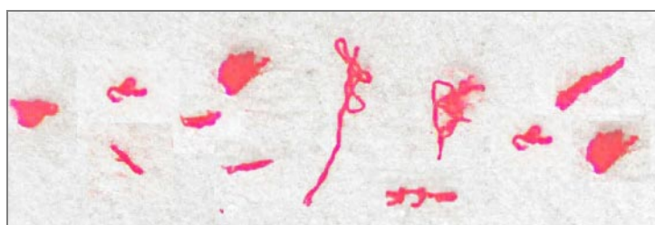
Abb. 40: Vergrößerte Ansicht des Faserabriebs auf dem Klebestreifen
