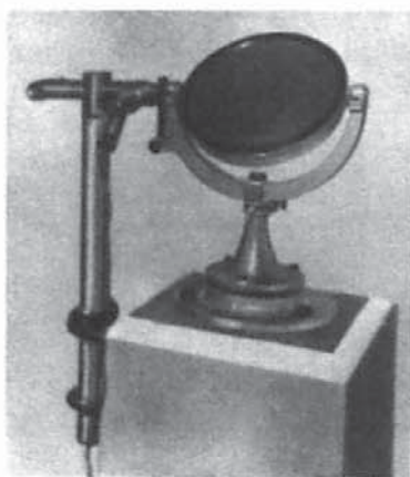
Abb. 13. Ansicht des kleinen, unter 45^\circ geneigten Planspiegels, der das vom Turmteleskop in das Laboratorium fallende Licht nach der Spaltwand ablenkt. An demselben Pfeiler links das Pointierfernrohr für den Beobachter bei langen Expositionen. Die beiden Backen des Spaltes sind hoch poliert und die Ebene des Spaltes leicht geneigt, so daß der nicht durch den Spalt fallende, sondern an den Spaltbacken reflektierte Anteil des Lichtes eines Sternes in das Objektiv des Pointierfernrohrs geworfen wird. Der am Pointierfernrohr sitzende Beobachter hat daselbst alle Schalter zur Regulierung des Teleskops zur Hand, kann also einerseits durch Änderung der Kippung des Gegenspiegels dafür sorgen, daß das Sternbild in der gewünschten Höhe den Spalt passiert, andererseits durch Beschleunigung oder Verlangsamung des Regulators, der den Zolostatenspiegel der Drehung der Himmelssphäre nachführt, verhindern, daß das Sternbild vom Spalt abwandert. Schließlich kann er die große Linse des Turmteleskops von hier aus in Höhe verstellen, um das Bild des Sternes auf dem Spalt zu fokussieren.
