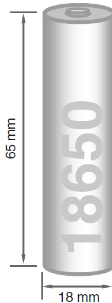
Abbildung 16: Schematische Darstellung einer kommerziellen 18650-Zelle, 18 entspricht dem Durchmesser der Zelle in mm, 650 entspricht der Länge in 0,1 mm 25 .
