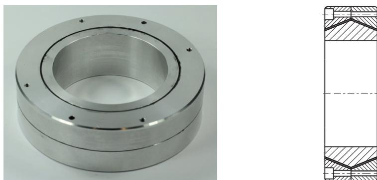
**Abb. 4.17.** Ringvariante mit elastischer Zwischenschicht aus Polyurethan (V3.1)
