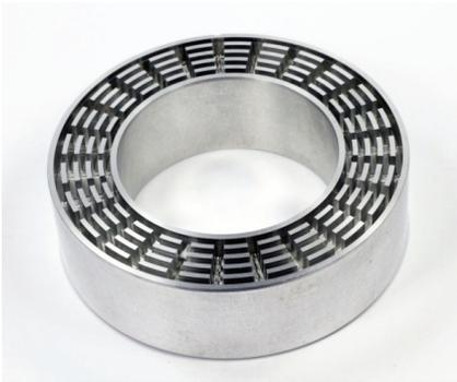
**Abb. 4.16.** Ringvariante mit dämpfender Maßnahme (V2.4) [112]
