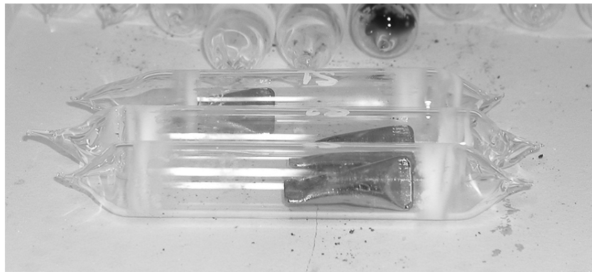
Abbildung 2.4: Metallampullen in Kieselglasüberampullen.
