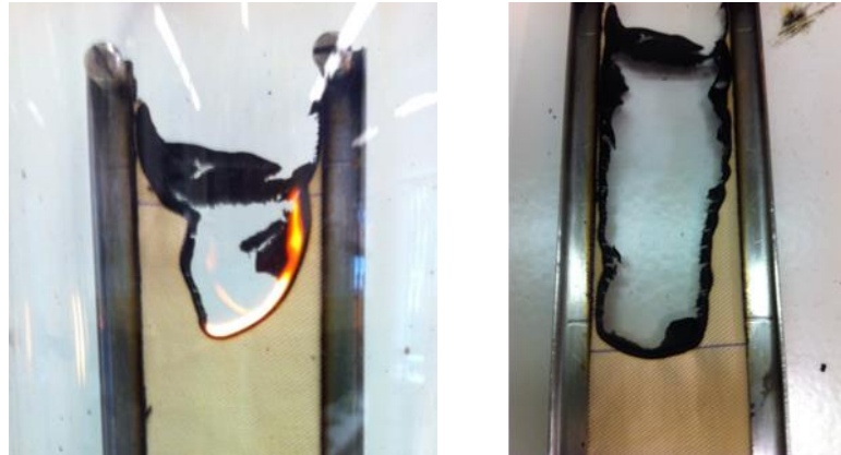
Abb. 84: Brennverhalten und Verkohlung von Cell-PNS.
