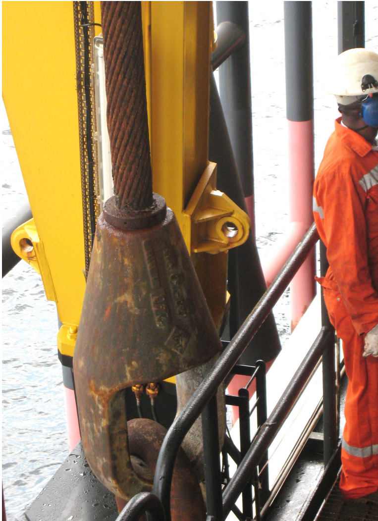
Abbildung 4: Hubseil einer Winde auf einer Offshore-Plattform, Durchmesser 120 mm
