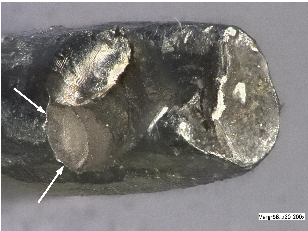
Abbildung 53: Drahtbruch mit Anzeichen von Ermüdung
