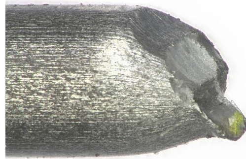
Abbildung 75: Draht A5, R = 2260 \text{ N/mm}^2 , 60 % Querdruck
