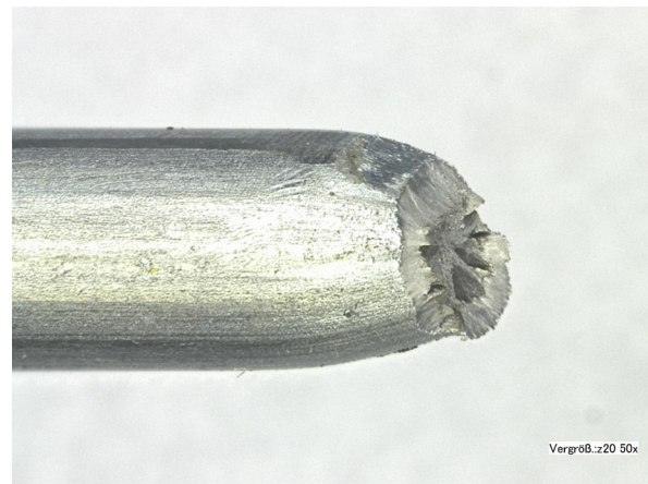
Abbildung 85: Draht B9, R = 2160 \text{ N/mm}^2 , 30 % Querdruck
