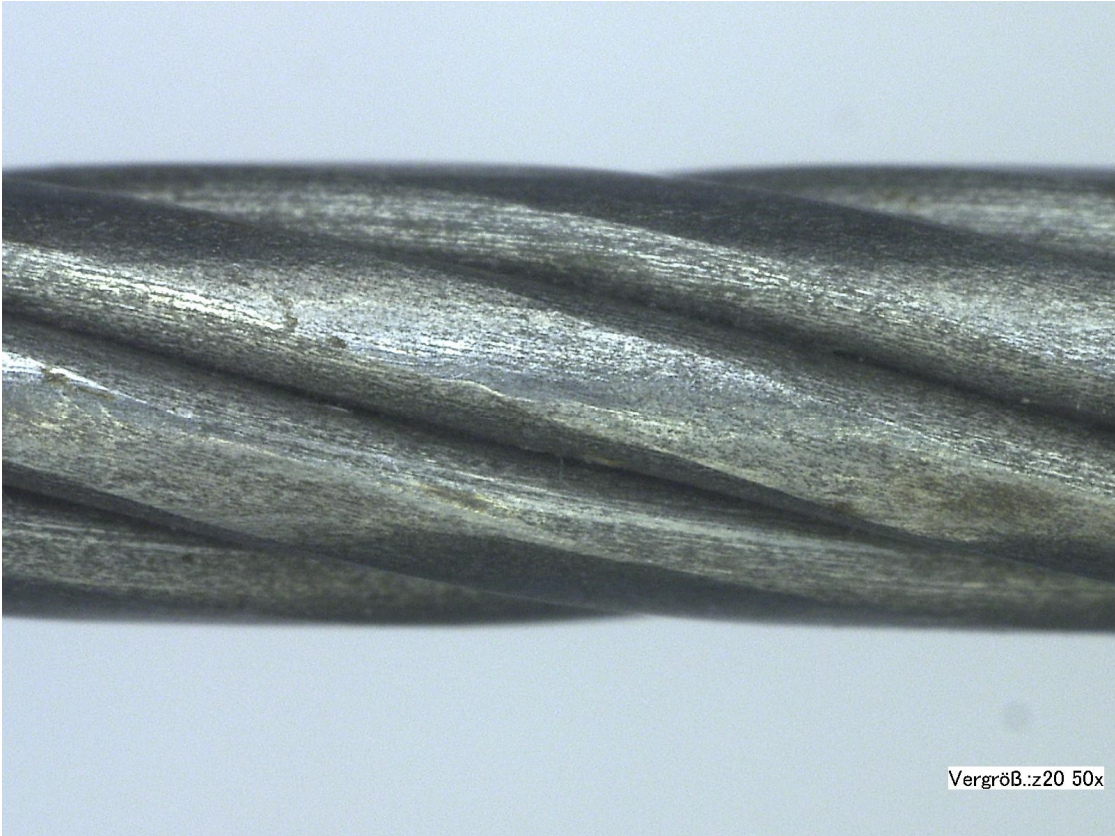
Abbildung 49: Außenlitze von Seil 1/16, Neuzustand
