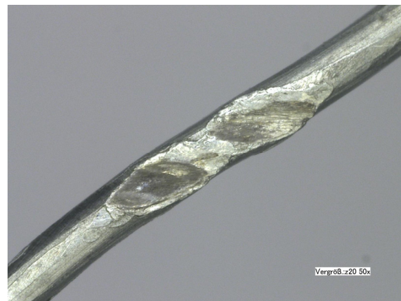
Abbildung 60: Druckstellen nach 8000 Biegewechseln
