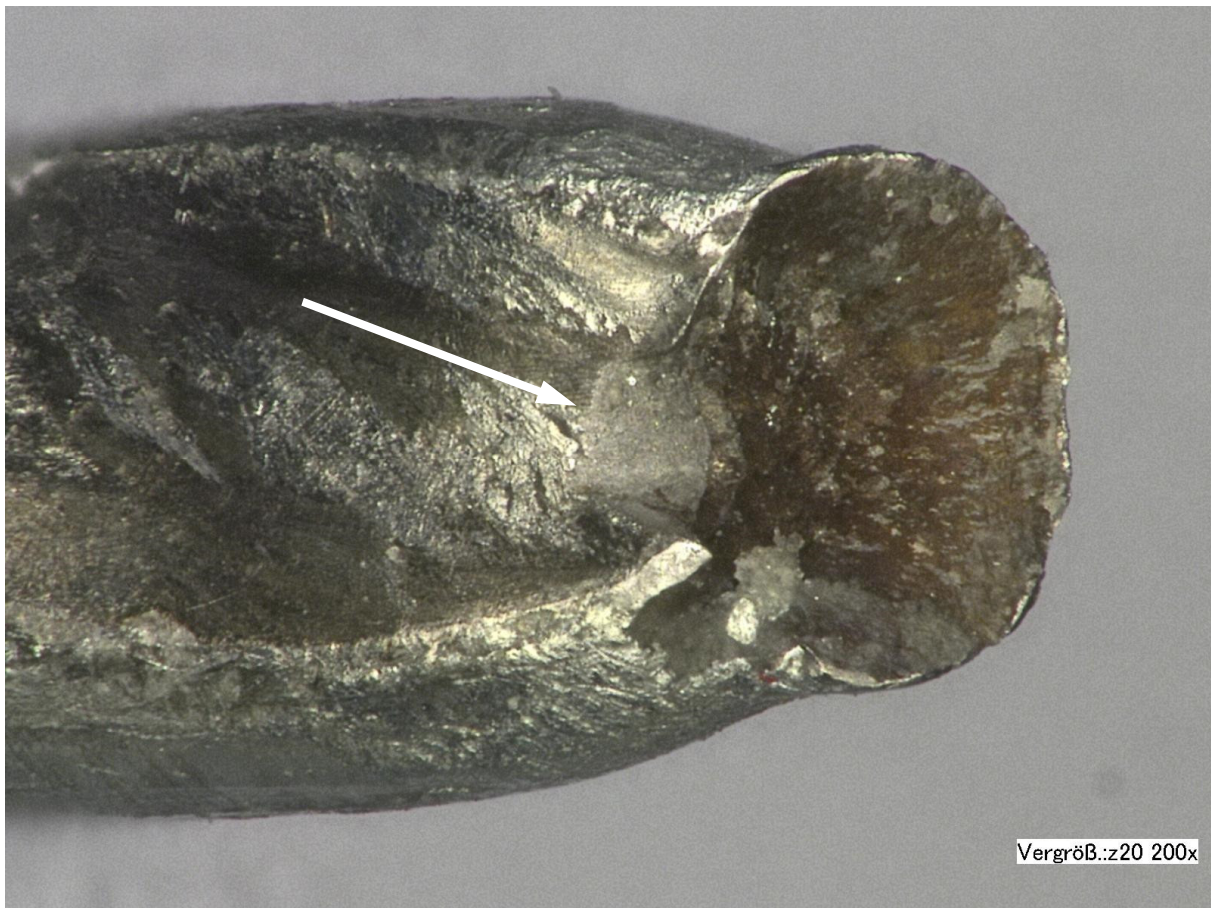
Abbildung 56: Gewaltbruch mit Druckstelle
