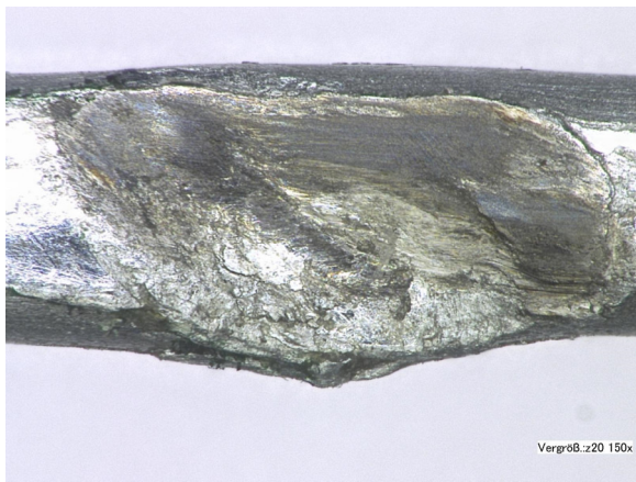
Abbildung 64: Druckstelle nach 8000 Biege- wechselln
