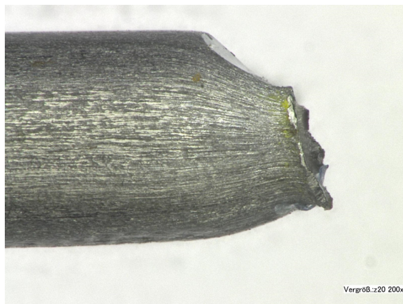
Abbildung 78: Draht A1, R = 1770 \text{ N/mm}^2 , 70 % Querdruck, Bruchende 2
