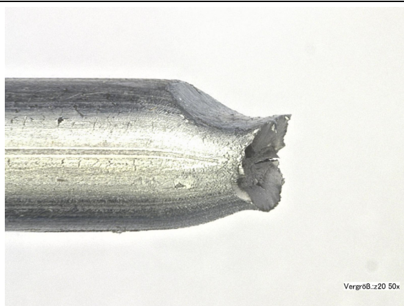
Abbildung 86: Draht B3, R = 1770 \text{ N/mm}^2 , 70 % Querdruck, Bruchende 1
