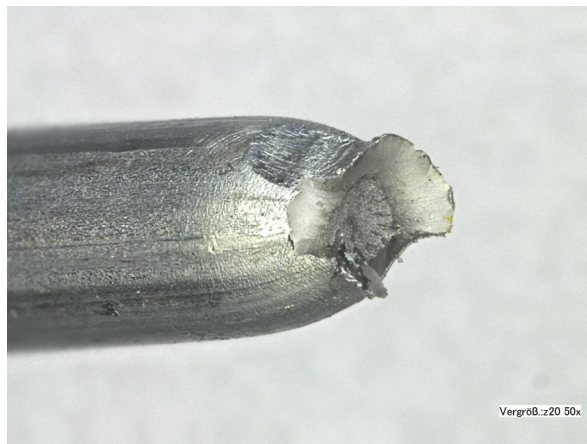
Abbildung 84: Draht B3, R = 1770 \text{ N/mm}^2 , 30 % Querdruck
