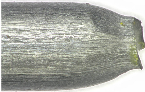
Abbildung 70: Draht A1, R = 1770 \text{ N/mm}^2 , 20 % Querdruck
