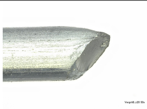
Abbildung 93: Draht B9, R = 2160 \text{ N/mm}^2 , 80 % Querdruck, Bruchende 2
