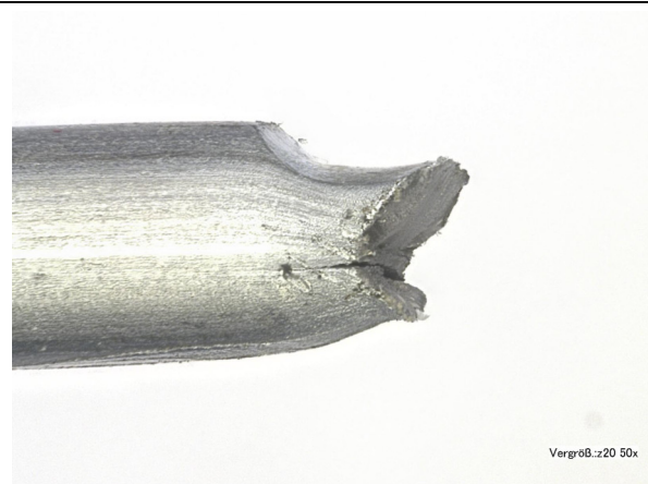
Abbildung 87: Draht B9, R = 2160 \text{ N/mm}^2 , 70 % Querdruck, Bruchende 1
