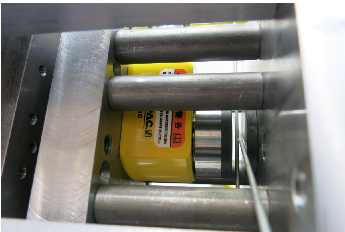
Abbildung 68: Presszylinder und Versuchsdrhte im Detail
