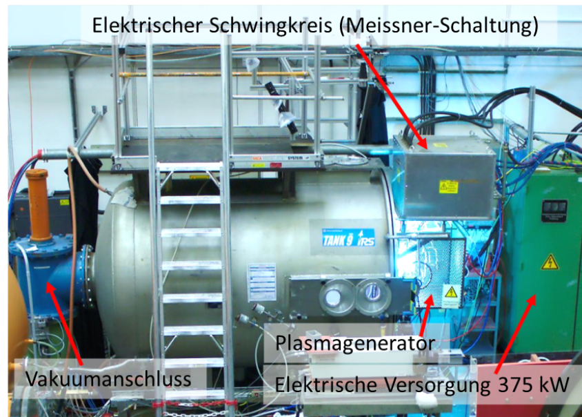
Bild 3.1: Der Plasmawindkanal 3 (PWK3, Tank 9) am Institut für Raumfahrtssysteme der Universität Stuttgart
