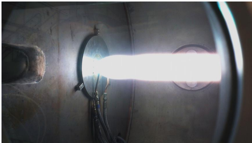
Bild 3.5: CO 2 -Plasmaströmung des IPG4 im PWK3 im induktiven Modus
