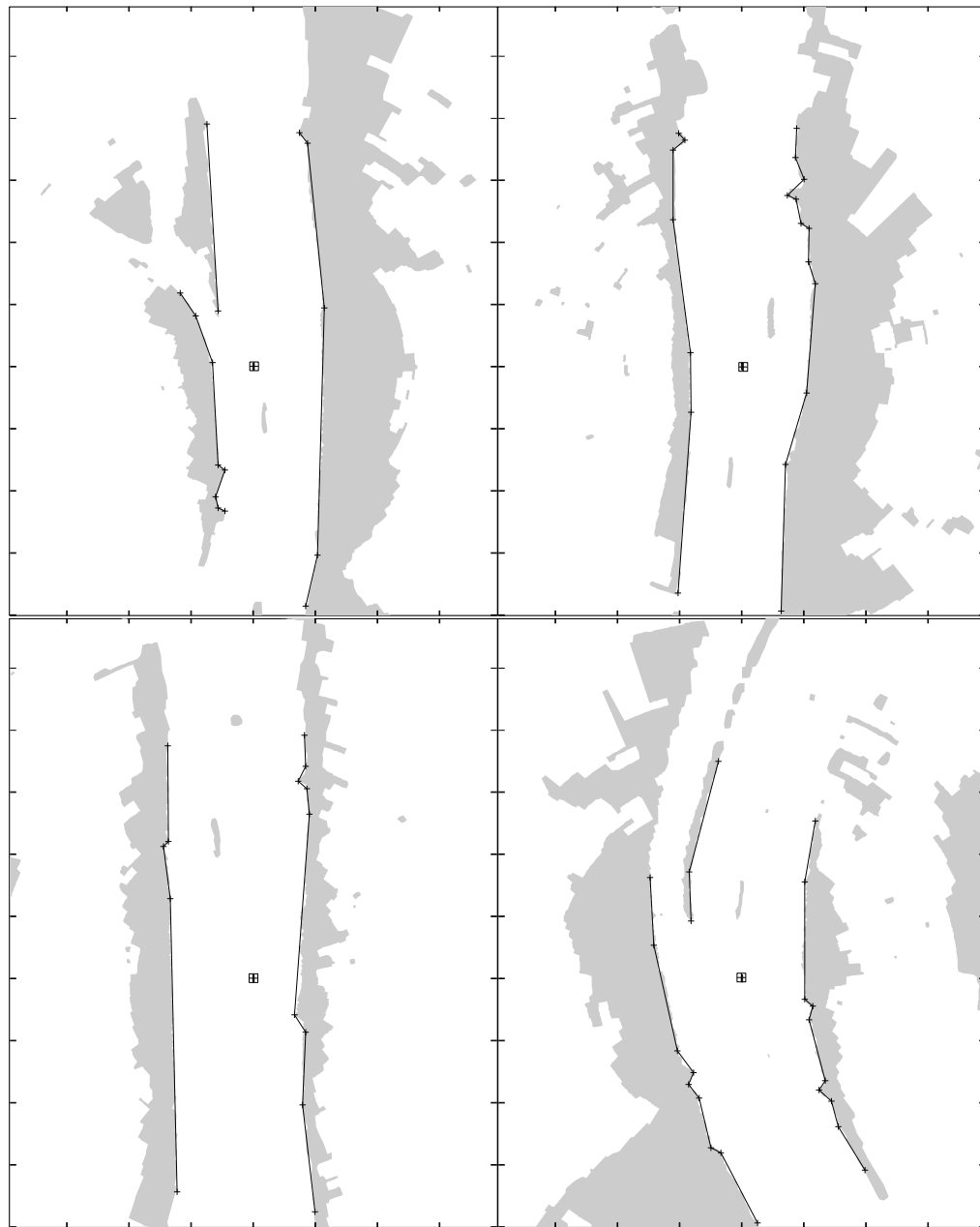
Abbildung 4.9: Approximation der Uferlinien in einem Radarbild
