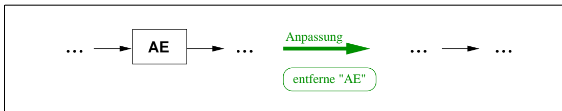
Abbildung 3.2: Strikt lokale Sicht: Entfernen einer Arbeitseinheit
