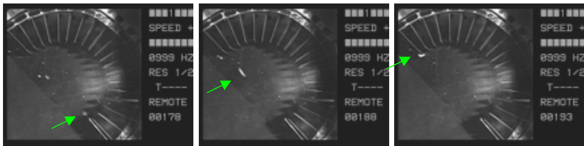
Bild 6.47: Spanflugsequenz ohne Prallwand
