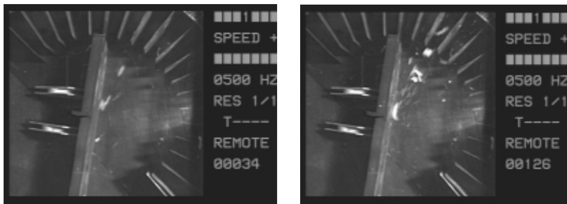
Bild 6.10: Reflexionsverhalten Buche bei \alpha = 50^\circ
