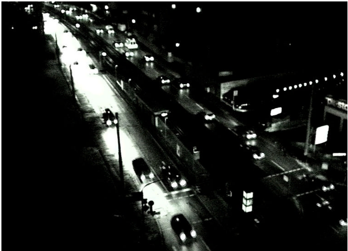
Abb.24: Messstrecke bei Nacht, aufgenommen mit IR-Modus und 720 nm - Filter
