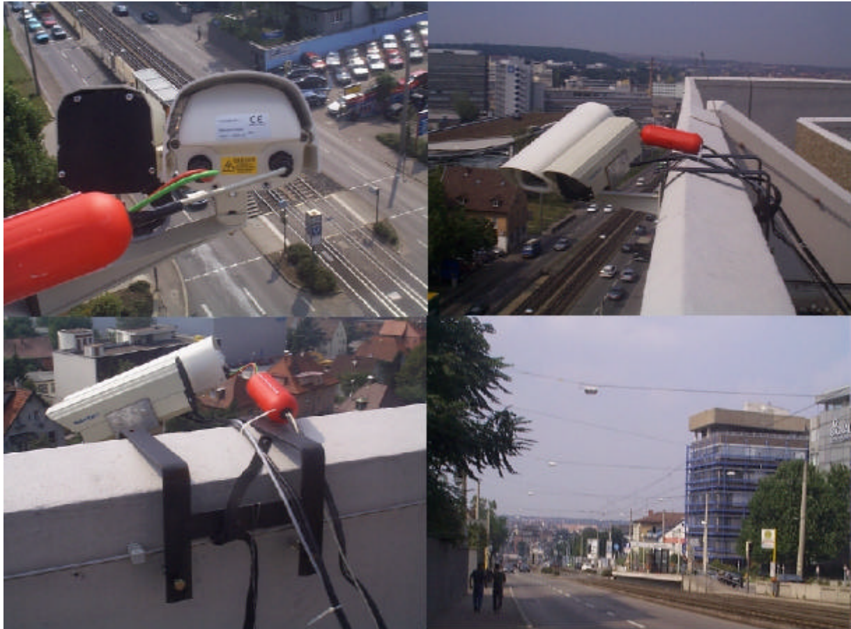
Abb.8: Befestigung beider Kameras auf einem Träger
