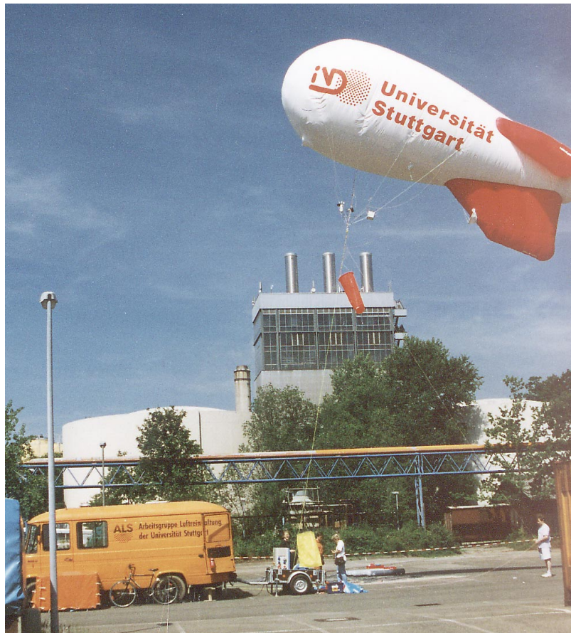
Bild 3-2: Fesselballon der Universität Stuttgart mit 56 m 3 Fassungsvermögen
