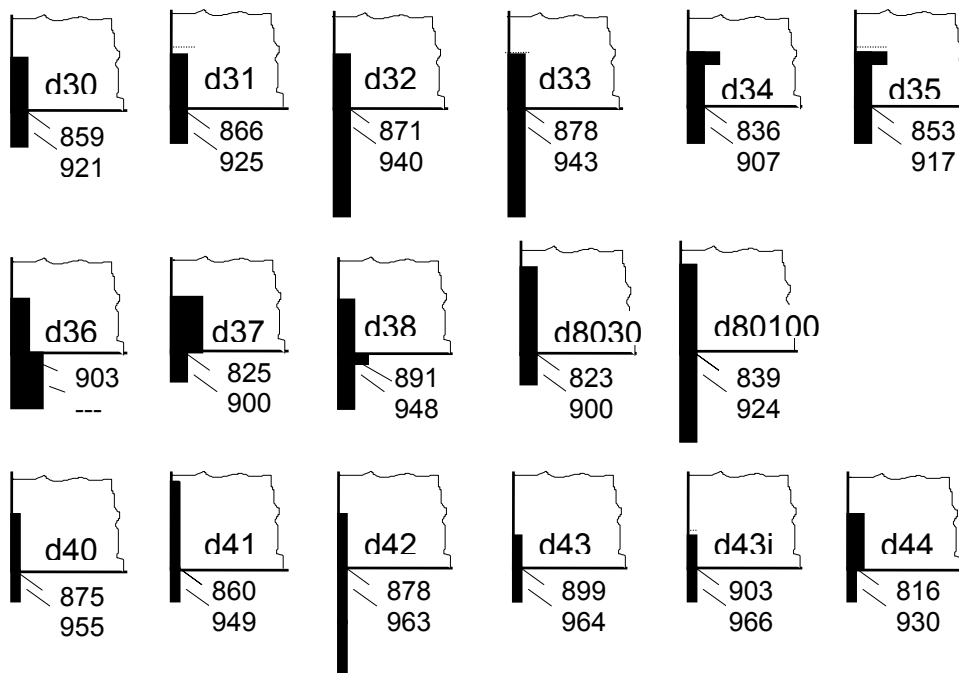
Bild 4.8: Berechnete Temperaturen nach 90 Minuten ETK-Beanspruchung
