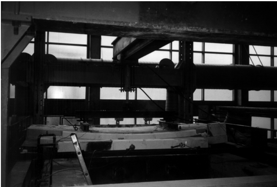
Bild 7.6: Belastung der Stahlbetonplatten während der Prüfungen
