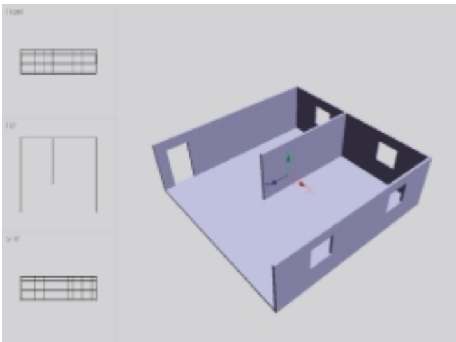
Noch mehr „divide et impera“: Die raumpartitionierende Oktalbaumstruktur, eingesetzt zur Detektion von Inkonsistenzen in digitalen Architekturmodellen.
