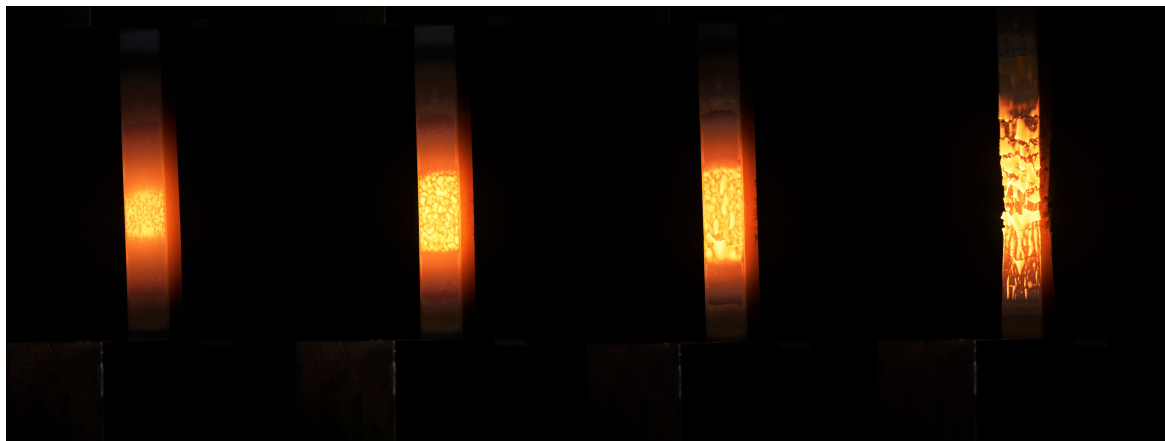
(e) Flüchtige Oxidationsschicht nach 137 s. (f) Stabile Oxidationsschicht mit beginnender Rissbildung nach 130 s. (g) Abreißen der Oxidschicht nach 287 s. (h) Deformation und lokales Abplatzen der Oxidschicht nach 525 s.
