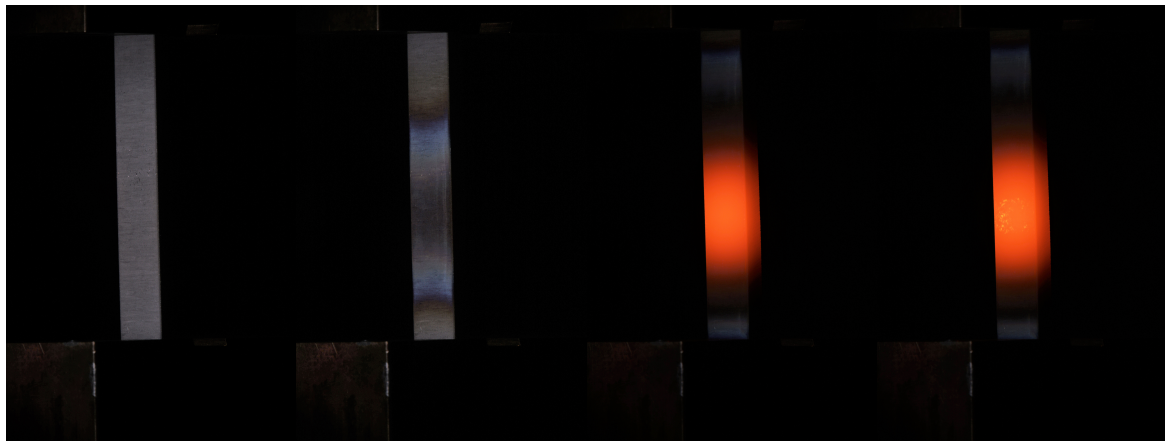
(a) Neumaterial bei Versuchsbeginn. (b) Anlassfarben nach 15 s. (c) Glühende Oberfläche nach 47 s. (d) Lokale Oxidation nach 51 s.
