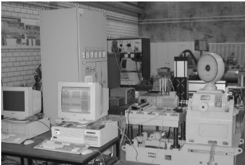
Bild 34: Motoren mit Diagnosesystem auf den Prüfständen und Visualisierungsrechner
