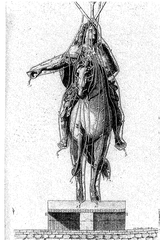
Abb. 1 Germain Boffrand, Illustration zum Guß der Reiterstatue Ludwigs XIV. von Girardon für die Place Vendôme (1695), Paris, 1743.
