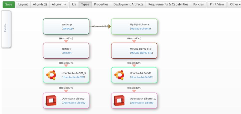
Abbildung 2.2: Eine Topologie im Winery Modeling Tool
