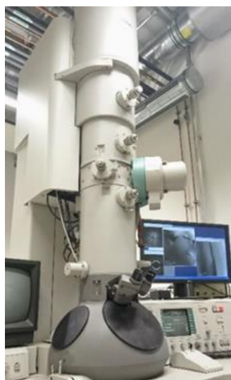
Figure 4-12: TEM Philips CM200 FEG.
