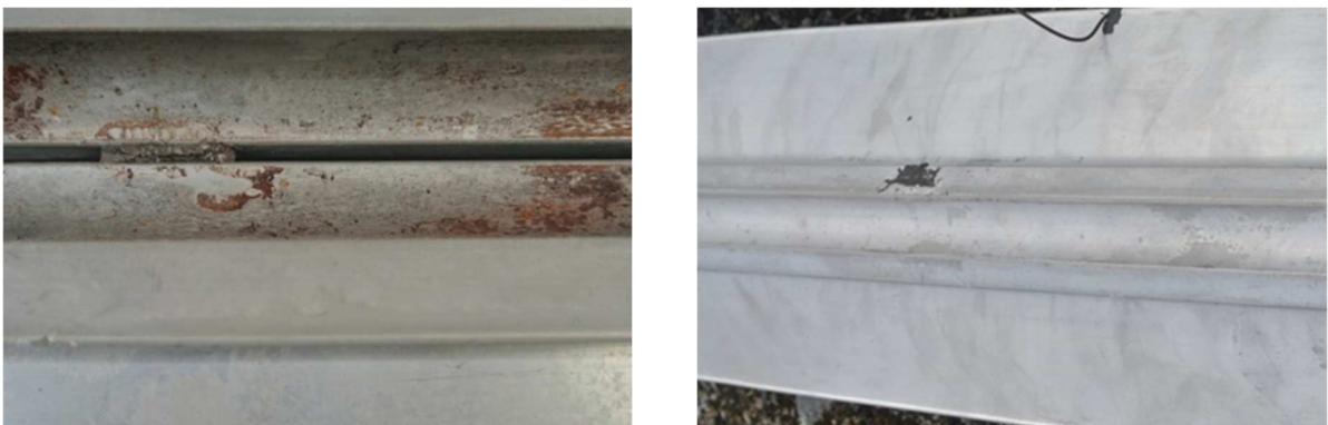
Abbildung 5-28: Vergleich der rippenseitigen Kontaktflächen für geklammerte (links) und gekrimpte Rohre (rechts)
