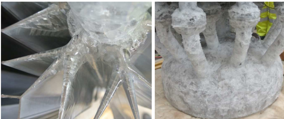
Abbildung 5-15: Betrachtung des erstarrten PCMs auf den Rippen nach ca. 1:30 h Erstarrung (links) und im Bereich des unteren Sammlers (rechts)
