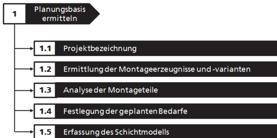
Abbildung 42: Verfahrensschritte der Phase „Planungsbasis ermitteln“
