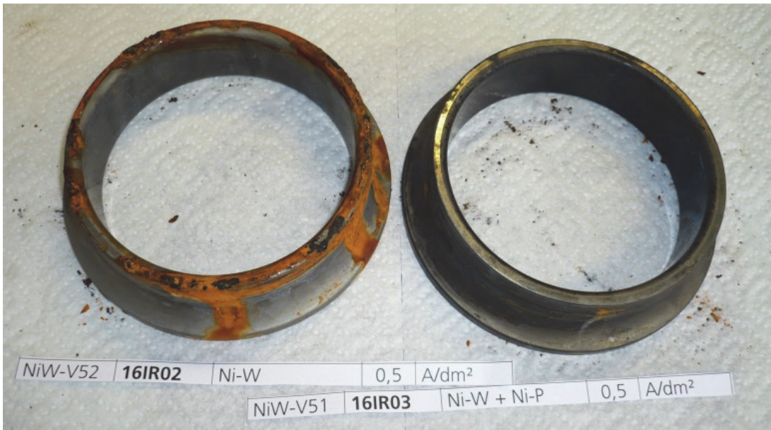
Abbildung 7.34: Lagerringe nach 1.000 h NSS: links Ni-W bei 0,5 A/dm 2 ; rechts Ni-W/Ni-P Ni-W bei 0,5 A/dm 2
